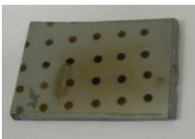
**Figura 36. Sustrato de Si-Cr-Co con crecimiento de CNT's localizado.**
