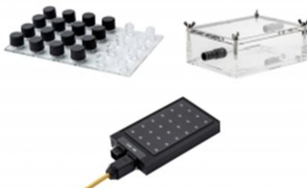
Figura 5 Respirómetro para larvas, el cual está compuesto por una cámara cerrada herméticamente y llena de agua (parte superior derecha) que en su interior se coloca una placa con 24 cámaras individuales con una capacidad de 750 \mu\text{L} cada una (parte superior izquierda), en cuyo interior se colocaron las larvas o el agua del tratamiento experimental sin larvas en el caso de los controles, la cual se coloca sobre un sensor que mediante un haz de luz registra la concentración de oxígeno cada lapso de tiempo (parte inferior de la imagen).
