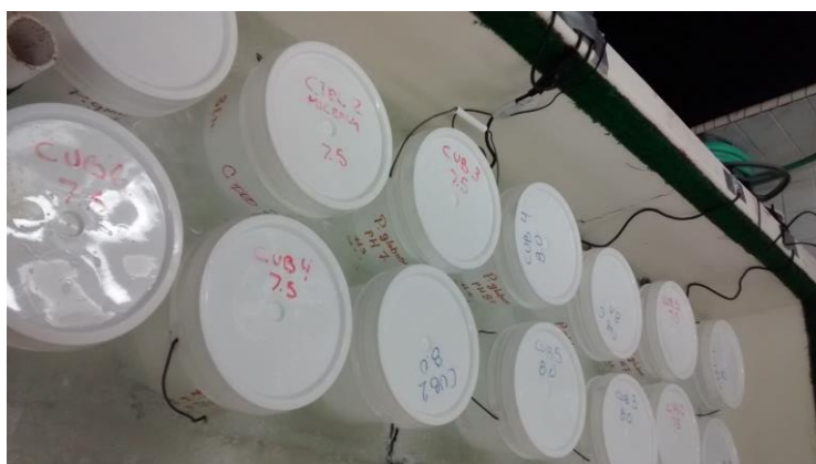
Figura 4 Sistema experimental, consistió en recipientes de alrededor de 4 litros donde se contuvieron a las larvas en los ensayos realizados, fueron colocados en un baño de agua para mantener una temperatura constante y evitar así las variaciones en el pH.
