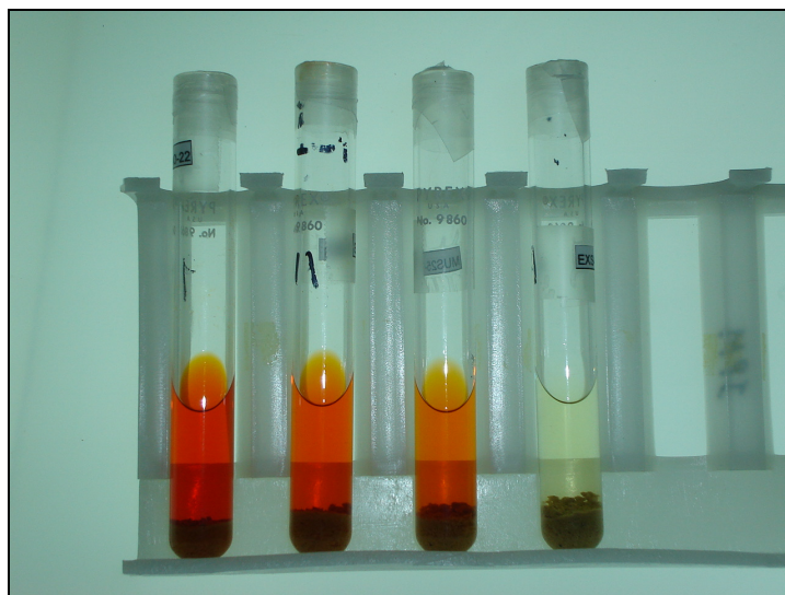
Figura. 7 Extracción de pigmento con acetona grado HPLC 99%.
