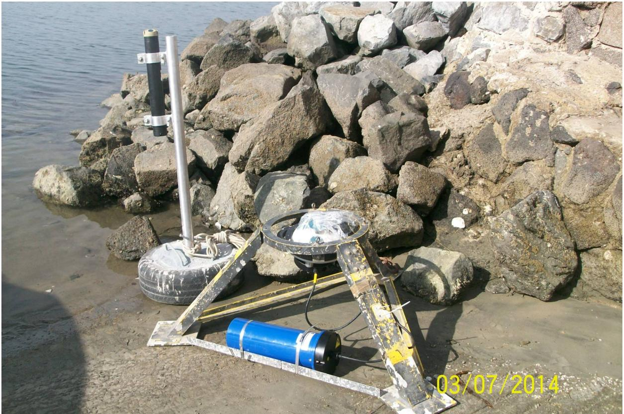
**Figura 1: Fotografía de los ADCP instalados durante la campaña de medición de oleaje y corrientes en la B-EPB; lado izquierdo Aquadopp profiler, a la derecha AWAC.**
