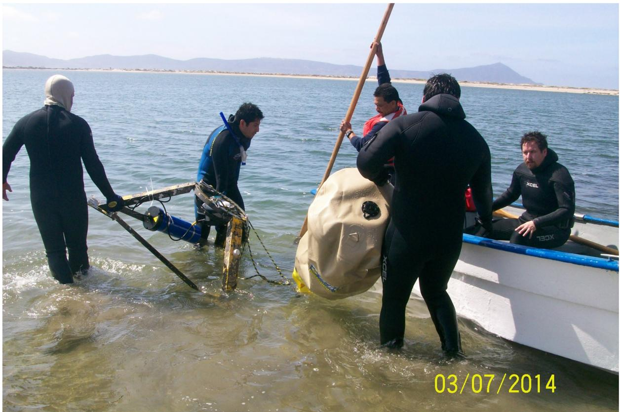
**Figura 6: Fotografía de las maniobras de instalación de ADCP AWAC en la B-EPB**
