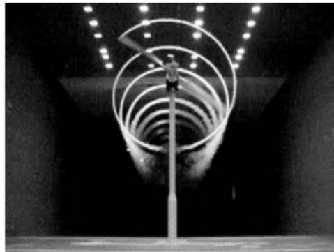
**Figura 1:** Visualización, mediante humo, de la estela de una hélice giratoria dentro de un túnel de viento. Fuente: Simms *et al.* (2001), extraído de Vermeer (2003).
