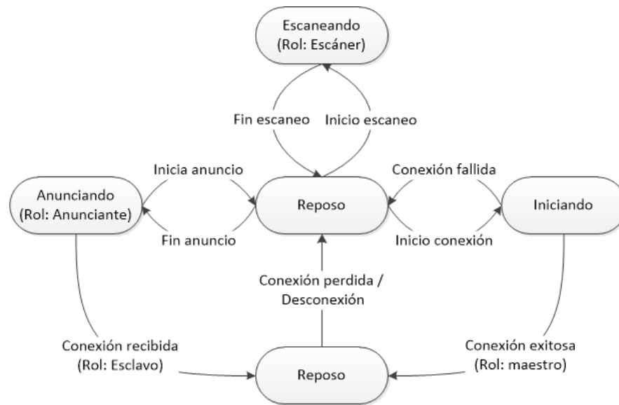
Figura 10. Diagrama de estados de los dispositivos Bluetooth Low Energy.
