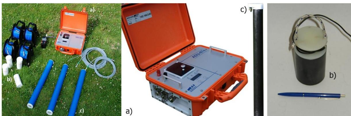
**Figura 16.** Equipo de registro magnetotelúrico: a) Consola de registro ADU-07e. b) Electrodo EFP-06. c) Bobinas de inducción MFS-06e (imágenes tomadas de las fichas técnicas de Metronix).
