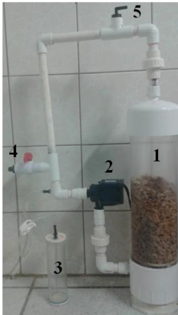
Figura 6. Reactor de calcio utilizado durante el acondicionamiento reproductivo del ostión Kumamoto en un SRA. (1) cámara de reacción con coral fósil, (2) bomba, (3) cámara de burbujas, (4) entrada de agua al reactor proveniente de los SRA y (5) retorno del agua a los SRA.
