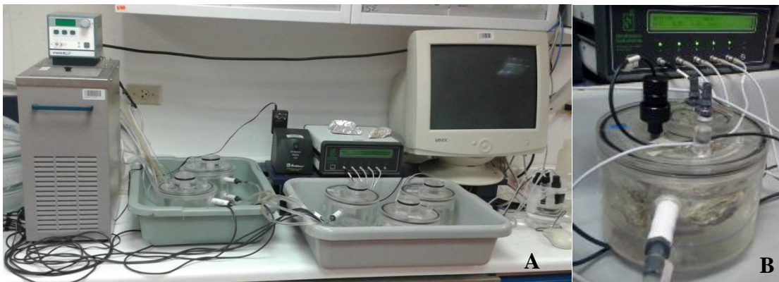
Figura 9. Equipo y para la determinación de consumo de oxígeno (A). Cámara metabólica y electrodo usados para la determinación de consumo de oxígeno (B).
