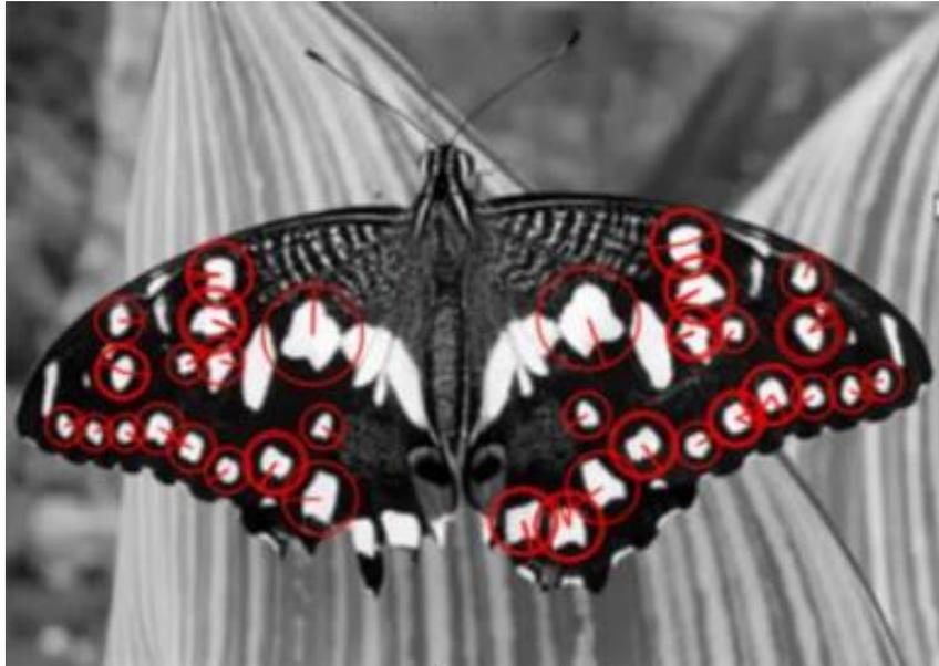
**Figura 20.**- Puntos de interés calculados con algoritmo SURF. Los puntos de interés son los centros de cada círculo. Figura recuperada el 29/07/17 de: [http://opencv-python-tutroals.readthedocs.io/en/latest/ images/surf\\_kp1.jpg](http://opencv-python-tutroals.readthedocs.io/en/latest/ images/surf_kp1.jpg)
