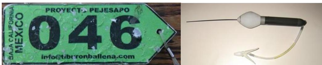
**Figura3. Marca convencional visual con código identificador (izquierda). Marca satelital tipo PAT con monofilamento y anclaje (derecha).**
