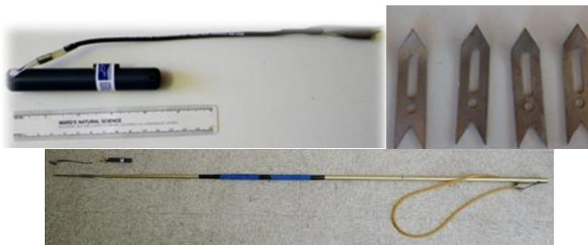
**Figura 13.** Marca acústica (transmisores VR2W-V16) con anclaje (izq.); anclaje tipo flecha utilizado para la inserción de la marca en el organismo (dcha); y arpón tipo hawaiana con la marca colocada para inserción (abajo).
