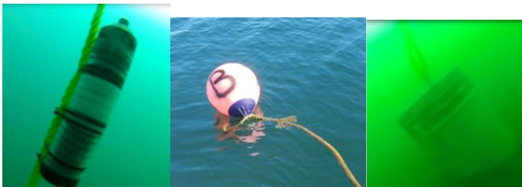
Figura 12. Receptor anclado a la línea madre mediante cinchos de plástico (izq), bolla marcada con las siglas TB para señalización del receptor (medio) y muerto para anclaje al fondo del receptor.
