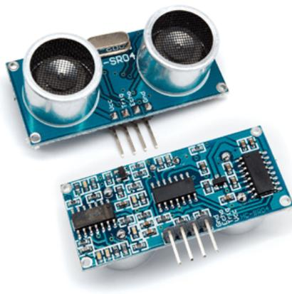
**Figura 10** Sensor para medir la distancia HC-SR04
