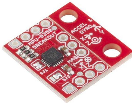
**Figura 11** Sensor magnetómetro MPU-9250, similar a una brújula
