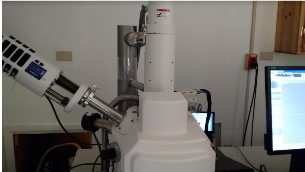
Figura 25: Microscopio SEM Hitachi SU3500, utilizado para observar la microestructura foliar de las especies de interés.
