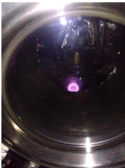
**Figura 16.** Plasma de Ar generado en la técnica de erosión iónica.
