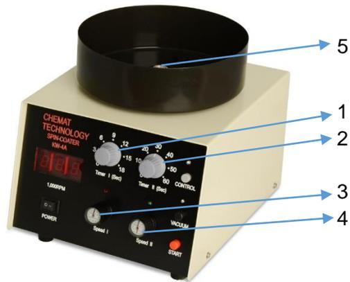
**Figura 13.** Equipo de centrifugado. (1) Temporizador para bajas revoluciones y para (2) altas revoluciones, (3) Velocidad de giro baja, y (4) alta, (5) porta sustratos
