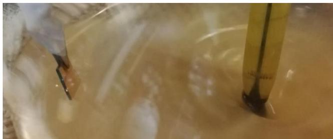
**Figura 5.** Imagen de la posición del sustrato durante la síntesis de una película de ZnO:Mn por CBD.
