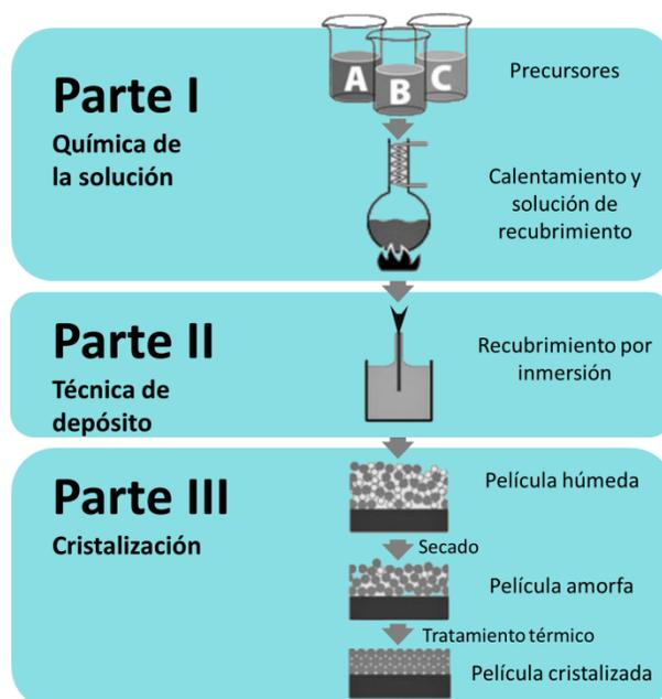
**Figura 4.** Esquema de la síntesis de depósito por baño químico utilizado para crecer películas delgadas.
