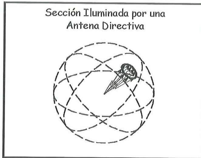
Figura 6 Iluminación de una antena direccional en comparación con una antena isotrópica.
