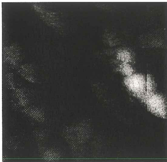
Figura 22. Imagen STM de 180\text{nm} \times 180\text{nm} en la que se observan granos de Au(111) antes de hornear en flama de hidrógeno.
