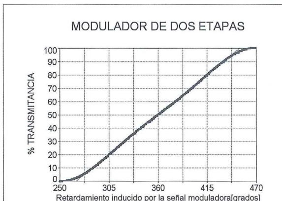
Fig. 43. Comparación de la función de transmitancia del modulador y una función lineal.
