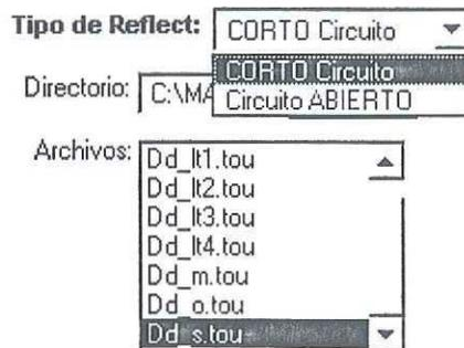
Figura 23: Menú “popup” para seleccionar el tipo de reflector y su correspondiente archivo de datos a utilizar en la calibración TRL/LRL(m) multilíneas.
