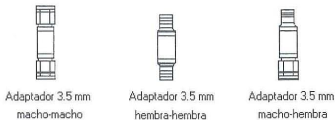
Figura 17: Adaptadores especiales 3.5mm para el kit de calibración coaxial HP85052C.
