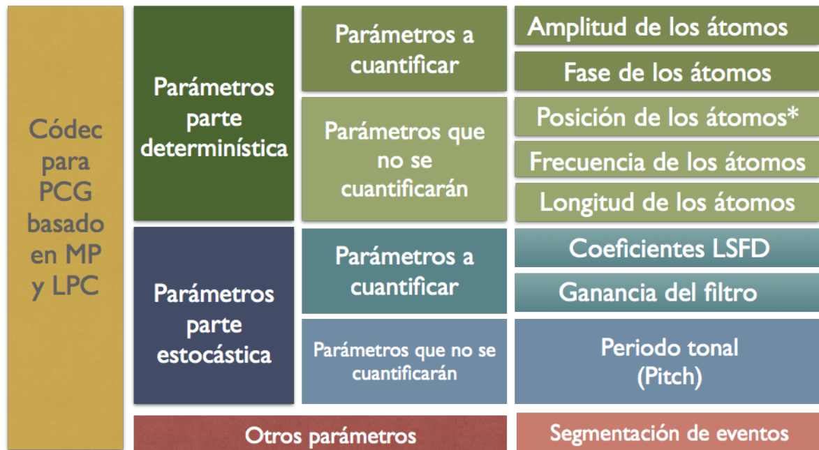
Figura 33: Parámetros extraídos de los modelados MP y LPC para el códec. Se indican los parámetros necesarios de cuantificar.
