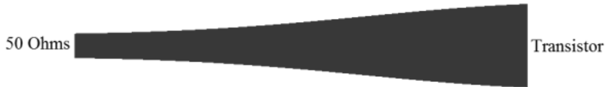
Figura 39. Adaptador de impedancias tipo Klopfenstein (de 50 \Omega a baja impedancia).
