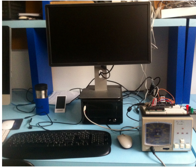
Figura 10: PC y controlador de rotor.
