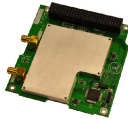
Figura 13: Radio Hellium y especificaciones (Tomado de AstroDev (2014b)).
