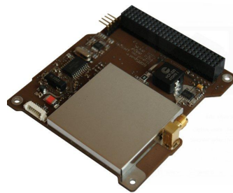
Figura 16: U482C y especificaciones (Tomado de GomeSpace (2014)).
