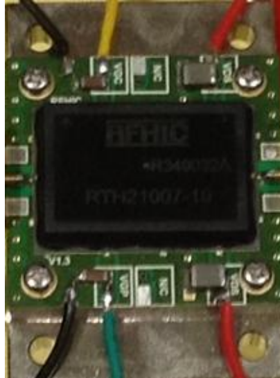
Figura 31. APD montado según las recomendaciones del fabricante.
