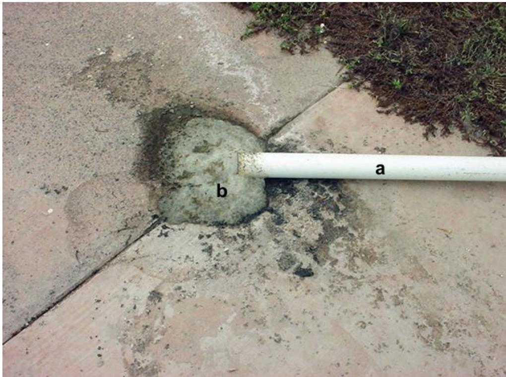
Foto 10. Desecho expulsado por la espumadera. a, tubo de PVC de 50 mm de diámetro; b, espuma.
