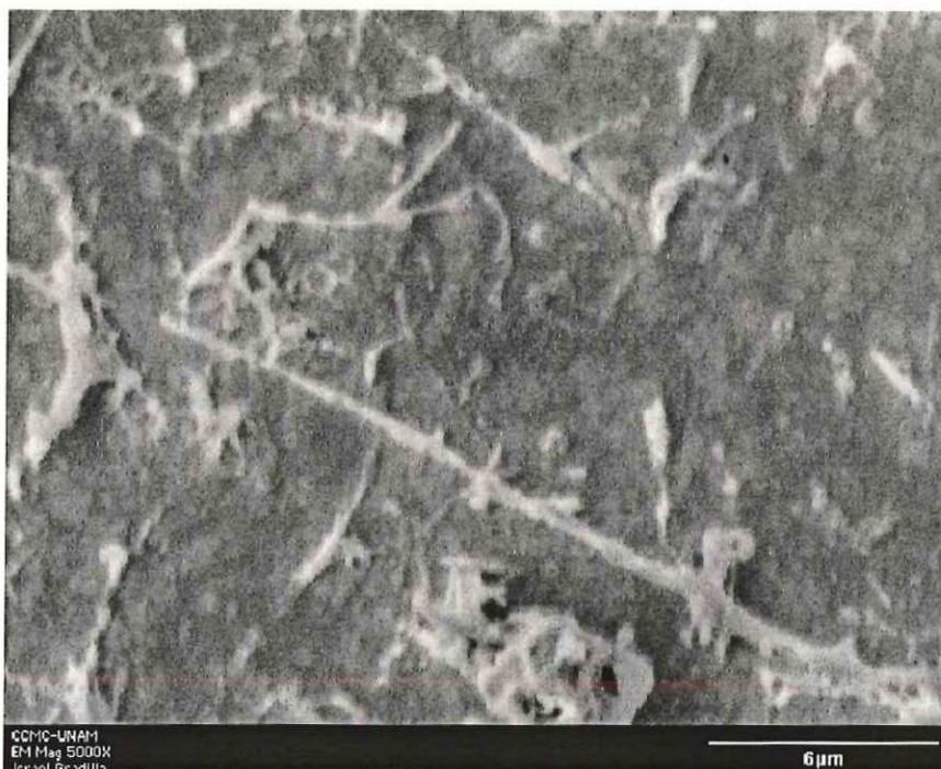
**Figura 25.** Micrografías de MEB de la película de SBT del sistema SBT/TiN/SiO<sub>2</sub>/Si crecido a 550 ° C y horneado a 730 ° C.
