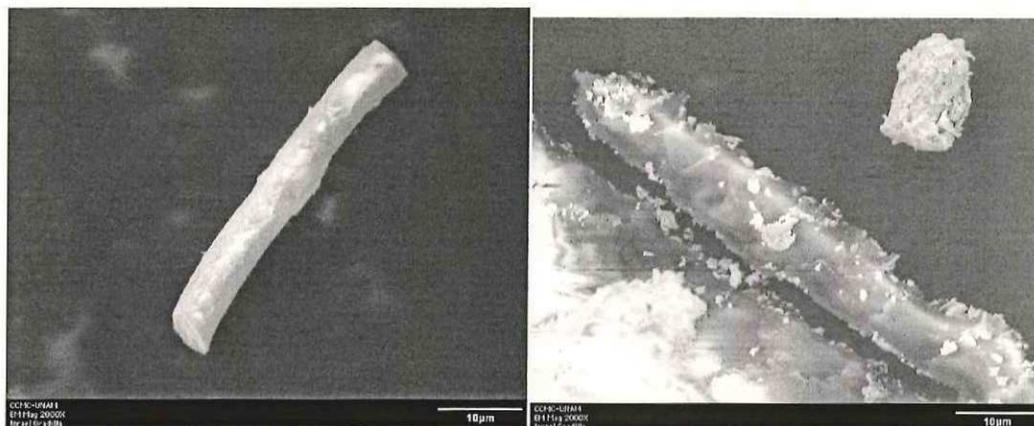
**Figura 29.** Micrografías de MEB detalle de micropilares de SBT obtenidos a partir de la técnica de sol gel –rocío pirolítico.
