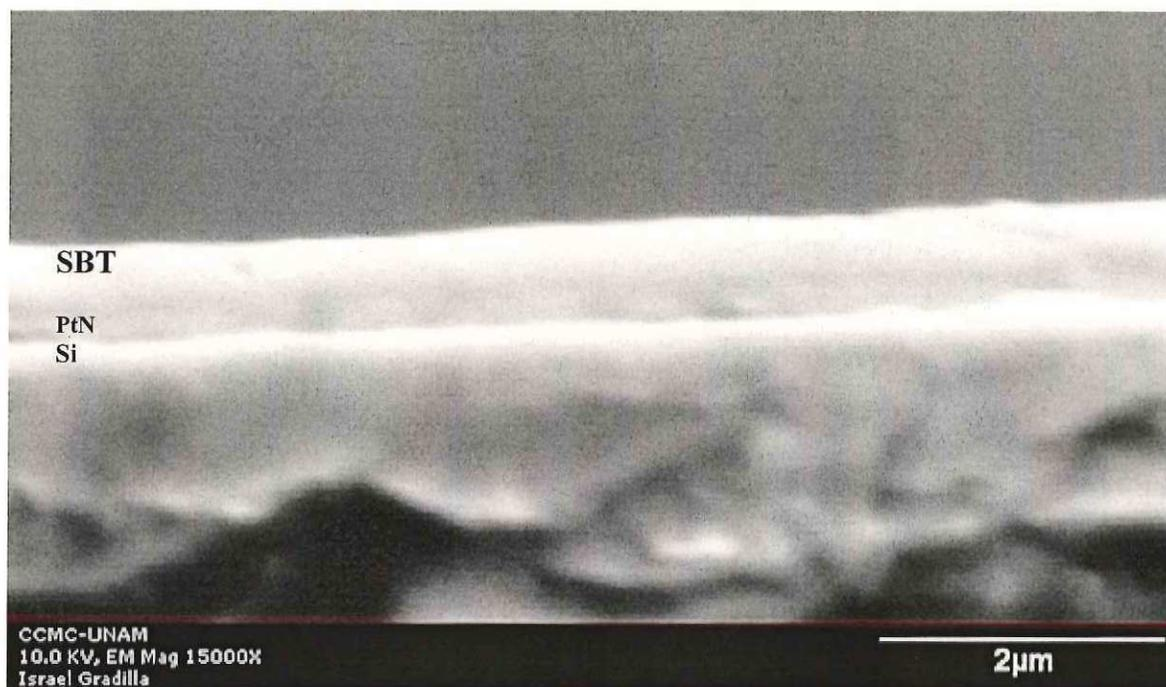
**Figura 23.** Micrografías de MEB de la película de SBT en el sistema multicapa SBT//PtN/SiO<sub>2</sub>/Si crecida a 550°C y sinterizada a 730°C.
