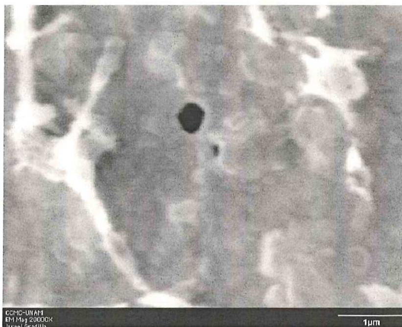
**Figura 28.** Micrografías de MEB. Detalle de microcanales en películas de SBT con estructura SBT/SiO<sub>2</sub>/Si crecida a 550°C y tratada térmicamente a 730°C.
