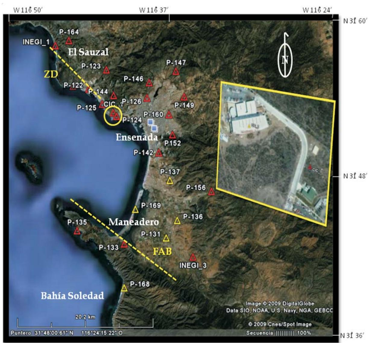
Figura 13.- Imagen Google donde se ubican las estaciones base CIC1 y CIC2 (recuadro) y el resto de las estaciones que conforman la red geodésica de la Ciudad y Puerto de Ensenada. Los vértices que fueron agregados en este trabajo: CIC2, P168, P169, P131, P136 y P137 están marcados con color amarillo.
