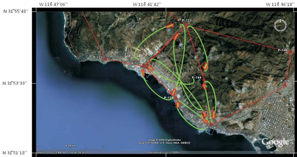
Figura 35.- Itinerario del levantamiento gravimétrico del Polígono 2 de la red gravimétrica: P124P144P124P123P144P122P123P125P122P124P125P124.
