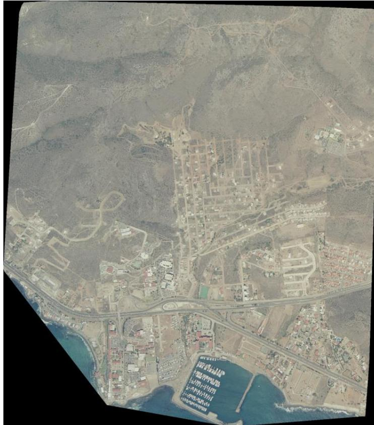
**Figura 18.** Ejemplo de ortofoto en la que se ha eliminado el efecto de distorsión por la óptica de la lente y el desplazamiento por relieve.
