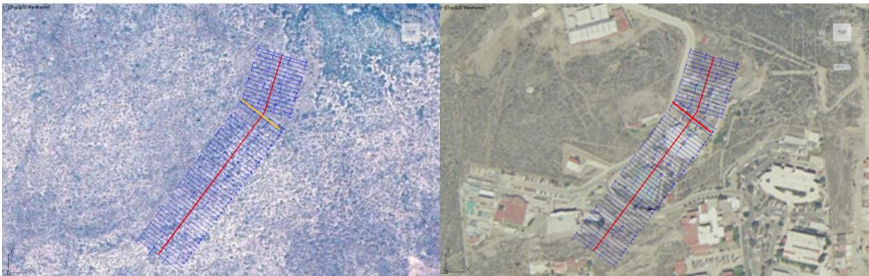
**Figura 50.** Trazo del eje principal del proyecto con estaciones marcadas a cada 5 metros y con secciones de 60 m, en la imagen izquierda se observa el perfil trazado sobre la ortofoto de 1973, mientras que en la derecha se tiene el mismo trazo sobre la ortofoto de 2006.
