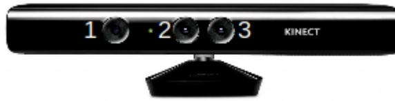
**Figura 8.** Microsoft Kinect: 1) Proyector IR. 2) Cámara RGB. 3) Cámara IR.
