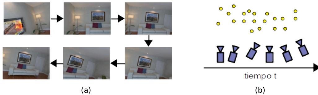
**Figura 4.** SLAM visual. (a) Secuencia de imágenes adquiridas por la cámara. (b) Estimación de la pose de la cámara y de la estructura del entorno.
