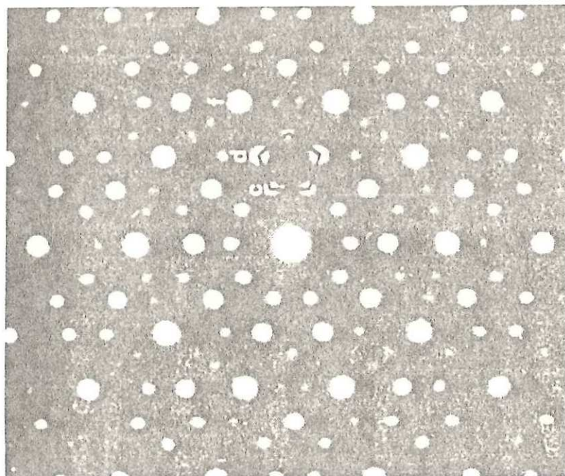
Figura 1. Patrón de difracción electrónica de la fase icosaedral en la dirección de simetría "prohibida" de orden cinco. Se pueden apreciar diferentes pentágonos. (Tomada de Shechtman et. al., 1984).
