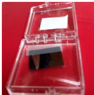
Figura 39. Muestra de Si (100) con un trozo de cinta adhesiva marca Scotch® 810 (“magic tape”).
