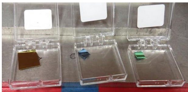
Figura 26. Muestras de 50, 100 y 200 nm sobre silicio (100).
