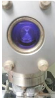
Figura 18. Cámara de reactor para pulverización catódica con plasma focalizado por el magnetrón del equipo (Universidad Autónoma de Baja California, FIAD).
