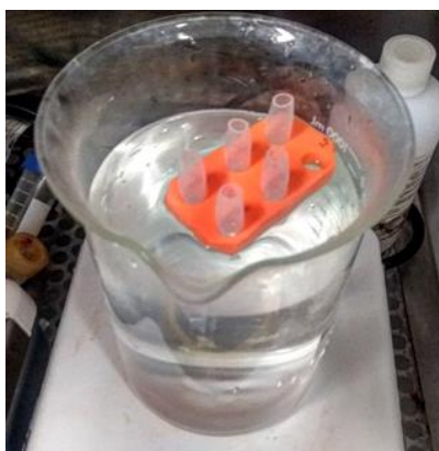
Figura 8. Sistema de microdiálisis montado para realizar los ensambles de prueba de la proteína de cápside del BMV con enzima Gcase en diferentes relaciones de masa. Las muestras están sobre una membrana de diálisis que permite la transferencia iónica con la solución amortiguadora.
