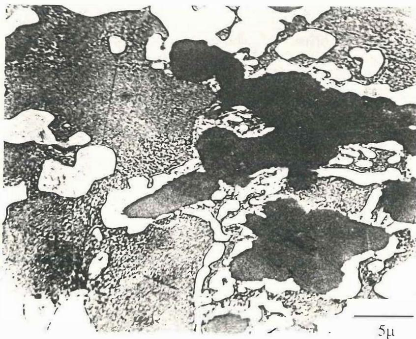
Figura 16 Estructura de colada continua observada en la aleación 4
