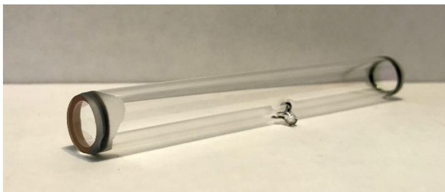
Figura 21. Celda de volumen con acetileno utilizada en los experimentos de esta investigación.
