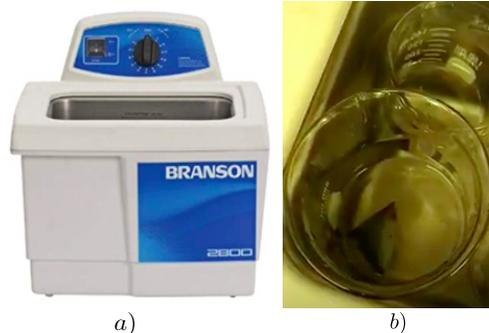
**Figura 49.** a) Equipo de ultrasonido empleado para remover la fotoresina. b) Sustrato sumergido en acetona.
