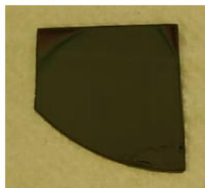
**Figura 43.** Sustrato con fotoresina depositada.
