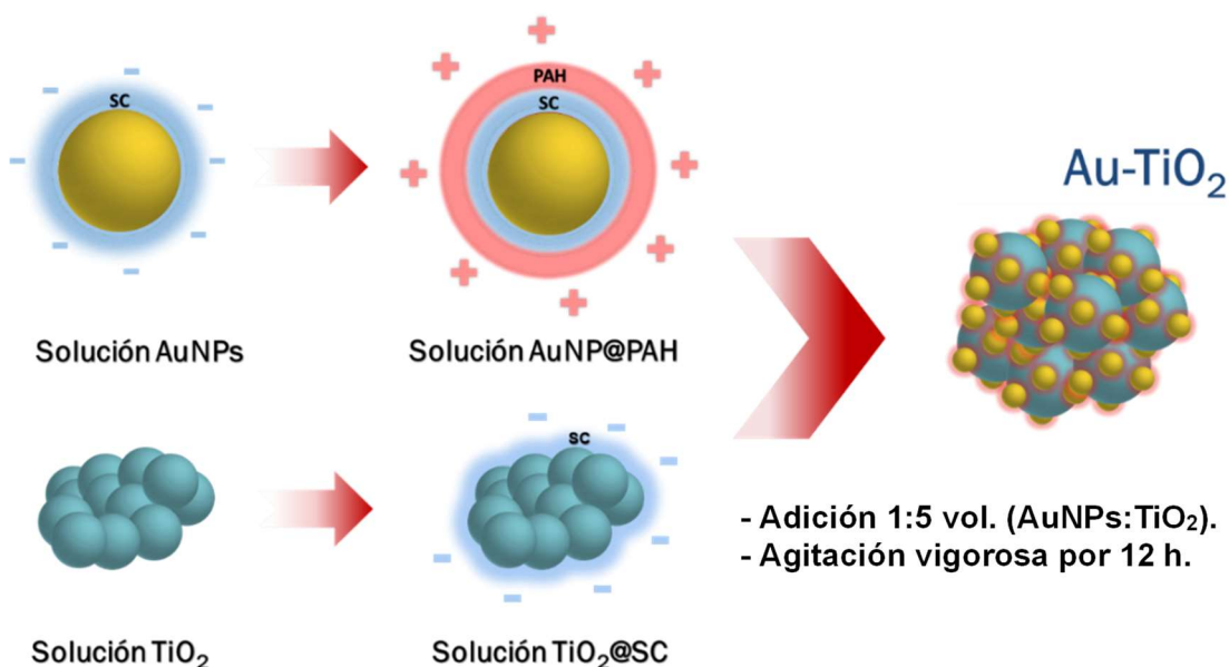
Figura 30. Ensamblaje de AuNPs-TiO 2 por modificación de cargas superficiales.
