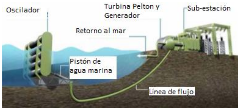
Figura 1. Convertidor de energía de oleaje oscilante: Aquamarine Power Oyster (Drew et al., 2009).
