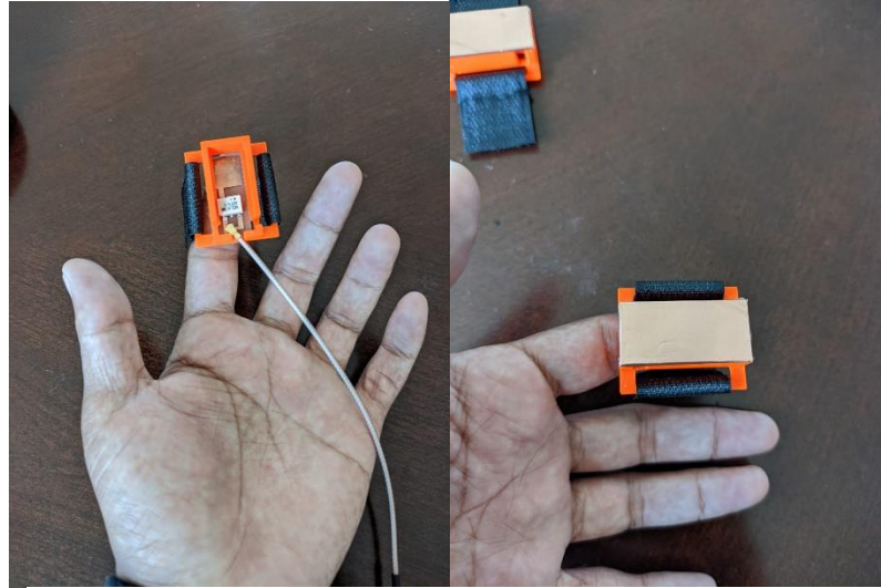
Figura 24: Electrodo con apantallamiento conectado a la mano.
