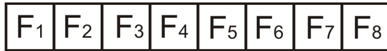
Figura 3: Ejemplo de un genotipo homogéneo. Todos los elementos son de tipo flotante.
