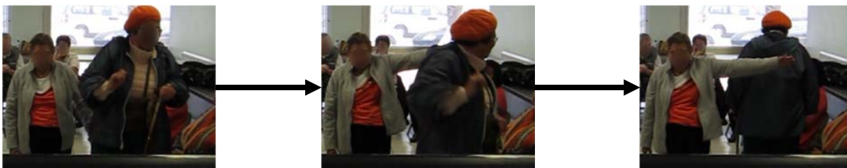
Figura 45. Falso negativo con un cuerpo interpuesto entre el jugador y el sensor.
