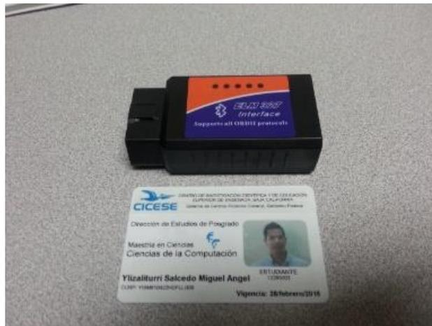
Figura 16. Dispositivo Bluetooth ELM327 que se conecta al vehículo en su puerto OBD-II.
