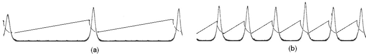
Figura 55 Esquema del empatamiento de una señal diente de sierra, que modula el Filtro FP, y el autopulsado. (a) la frecuencia de la modulación es igual a la frecuencia del autopulsado y (b) la frecuencia de modulación es 3 veces mayor al autopulsado.
