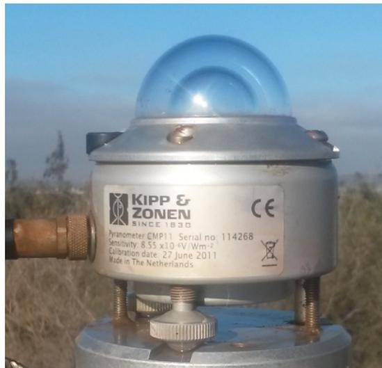
Figura 12. Piranómetro CMP11 donde se observa la última calibración que se le realizó al sensor (Imagen cortesía del Ing. Manuel E. Colima Sánchez de CONAGUA, 2016).
