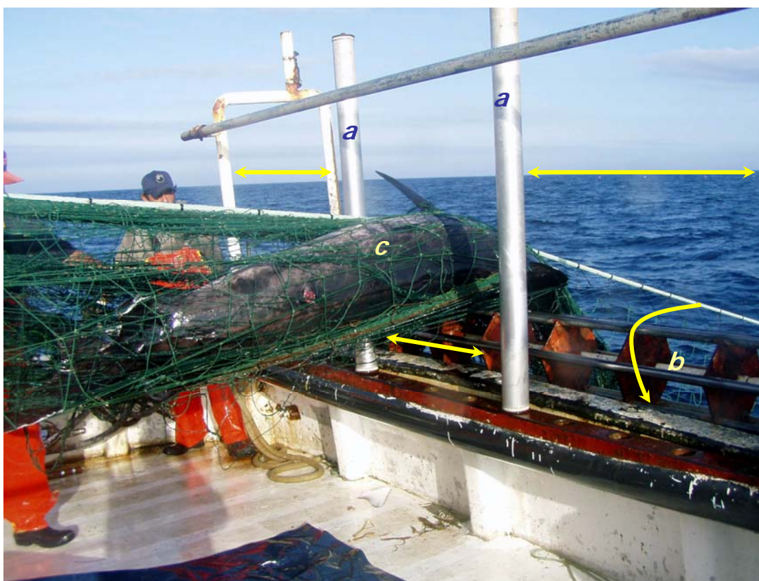
Figura 8. Mecanismo que facilita el cobrado de la red agallera de deriva en el B/M Corina del Mar : a) rodillos verticales b) rodillo horizontal c) pez espada ( Xiphias gladius ) capturado en la red. Las flechas en la imagen indican movimiento de los componentes.
