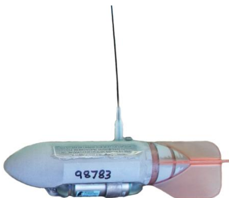
Figura 4. Marca transmisora de la posición geográfica en tiempo real y temperatura (SPOT).
