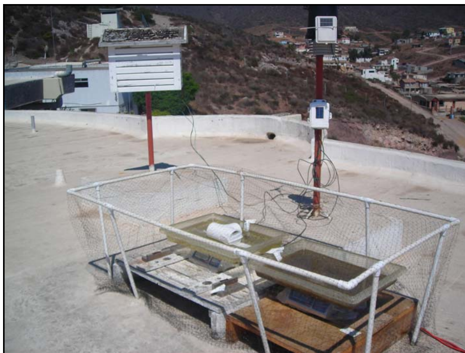
Figura 11. Malla protectora para evitar que las aves afecten las estimaciones de evaporación.
