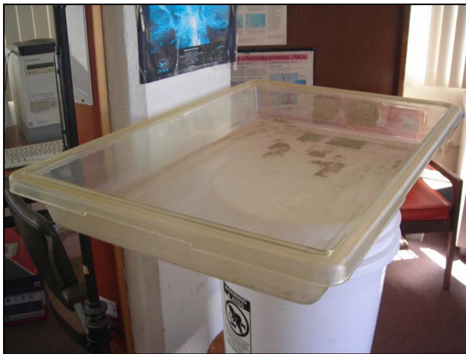
Figura 5. Bandeja de evaporación utilizada en el experimento principal.
