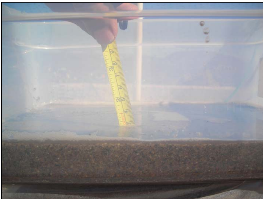
Figura 25. Espesor de la capa de arena húmeda más gruesa (0.03 m).
