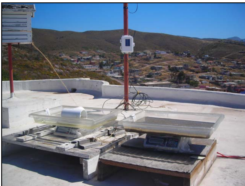
Figura 6. Charolas de evaporación colocadas junto a la estación meteorológica. Arena húmeda (derecha) y agua (izquierda).
