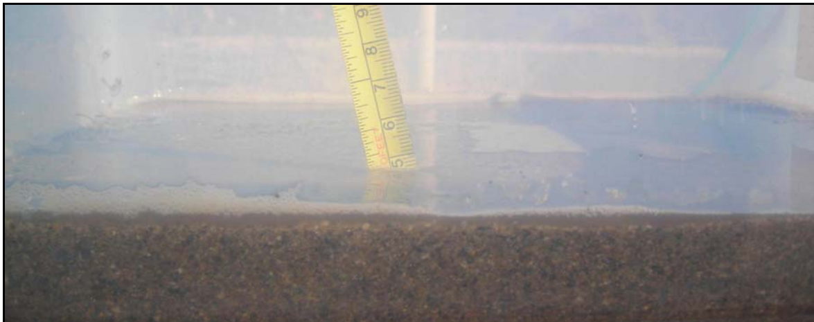
Figura 28. Aumento del espesor de la capa de arena a 0.05 m.
