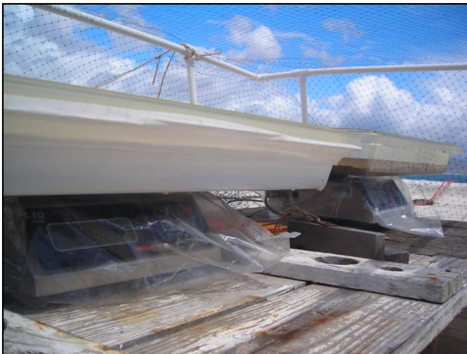
Figura 36. Del lado izquierdo bandeja con protección en las paredes laterales. Del lado derecho bandeja sin protección lateral.
