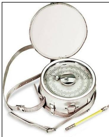
**Figura 9: Altímetro barométrico American Paulin Systems, modelo M-1. Rango de -1000 pies a +5000 pies de altura. Graduación de una pulgada. Precisión de  $\pm 1$  a 5 pies.**
