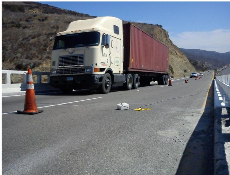
**Figura 17.** Sensor ubicado sobre la superficie de rodamiento mientras el tráfico fluía por el carril contiguo.
