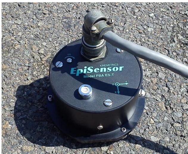
Figura 14. Acelerómetro triaxial EpiSensor FBA ES-T.
