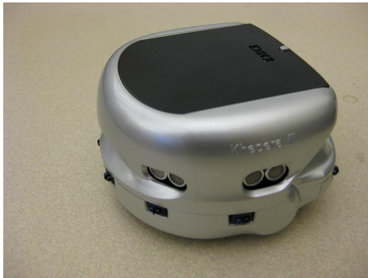
**Figura 30.** Robot móvil diferencial Khepera III, Laboratorio de Sincronización y Sistemas Complejos.
