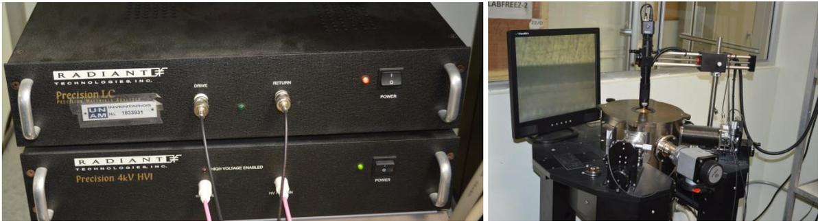
Figura 18. Estación de micromanipuladores y el sistema *Precision LC* de *Radiant Technologies* acoplado con una fuente de alto voltaje de hasta 4 kV.
