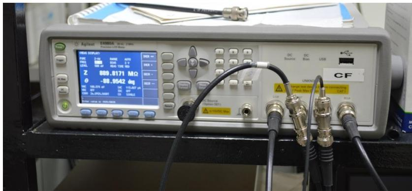
Figura 20. El puente de precisión *LCR Meter E4980A de Agilent*. Se utiliza para medir la permitividad, las pérdidas dieléctricas y la impedancia en función de frecuencia la frecuencia.
