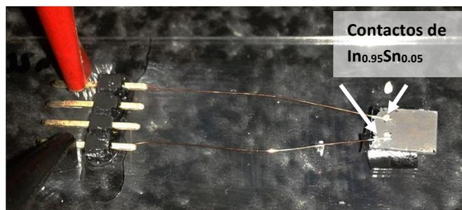
Figura 26. Arreglo utilizado para la toma de curvas de corriente-voltaje.
