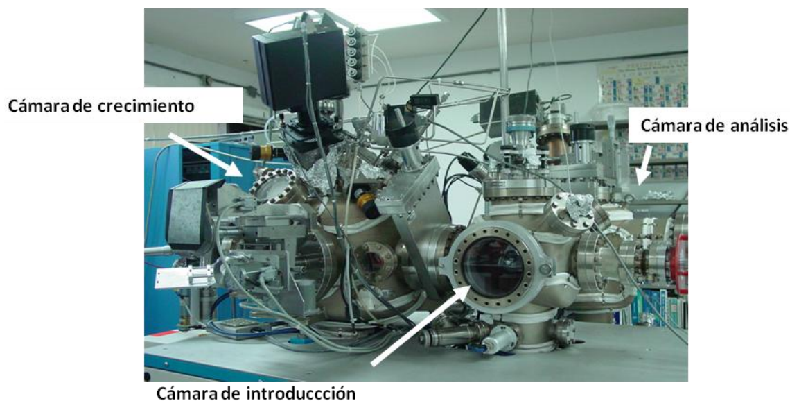
Figura 2: Fotografía del equipo Riber LDM 32 utilizado en este trabajo.
